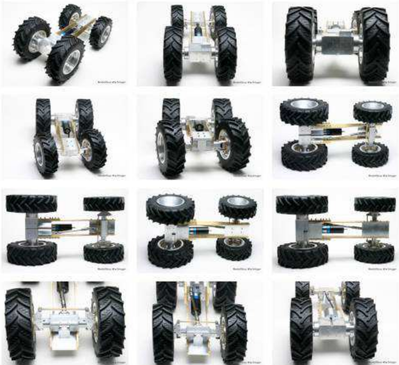
Abbildung 99: Chassis für eigene Konstruktionen im Maßstab 1:8
